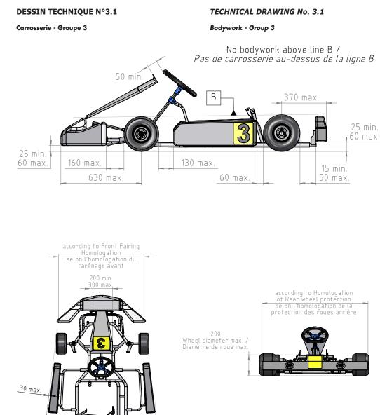
Minimum: Wheel in line with side bodywork and rear wheel protection / Minimum: Roue alignée avec la carrosserie latérale et la protection des roues arrière
